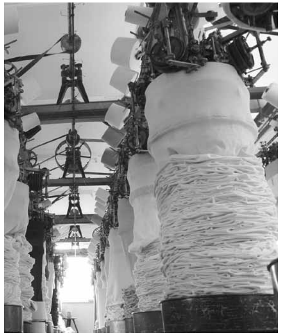
Fertigung von Schlauchware in den Heiligen Hallen.
