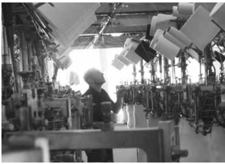
Fertigung von Schlauchware in den Heiligen Hallen.
